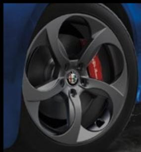
Roues sport de 18 po en aluminium incluses dans l'ensemble allure extérieure sport de la Giulia et dans l'ensemble performances plus du modèle Ti
