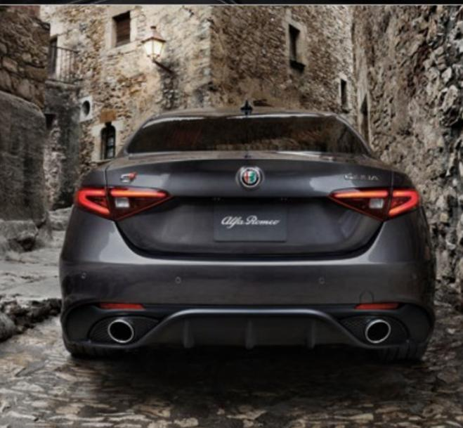
Un diffuseur arrière intégré, exclusif à la Giulia Ti Sport, dirige l'air et rehausse la stabilité à haute vitesse, tandis qu'un bouclier Sport intègre les embouts d'échappement bimode pour un style précis.
